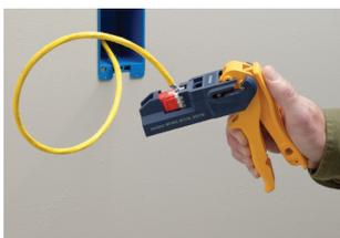
5. Apriete el gatillo completamente y retire el exceso de cable antes de volver a soltarlo.
