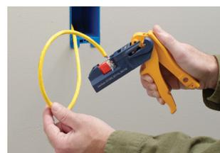
3. Inserte primero el conector en la parte frontal de JackRapid con las ranuras IDC en dirección a las cuchillas de JackRapid.
