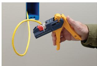
4. Asegúrese de que el conector se encuentra total y firmemente insertado en el alojamiento para conectores con las ranuras IDC en dirección a las cuchillas.
