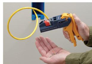
6. Los hilos quedarán cortados y asentados asegurando una sólida terminación.
