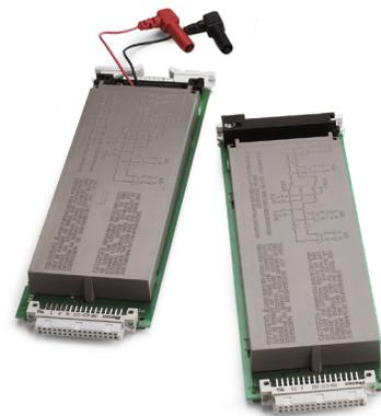
Use las tarjetas de escaneo opcionales para incrementar la capacidad de medición de voltaje de 10 distintos canales o de temperatura de 9 distintos termopares
