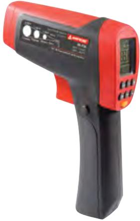
**IR-750** 50:1 Infrared Thermometer
