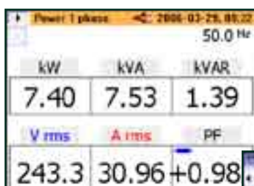
Medición del rendimiento del equipo: potencia consumida por cargas balanceadas monofásicas y trifásicas.
