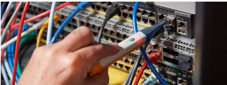
Determine si un transceptor está operativo. El FiberLert puede detectar señales de fibra sin hacer contacto.
